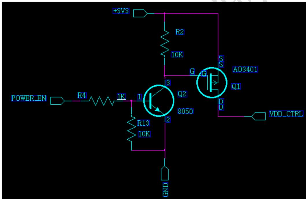
通过此电路控制 VDD\_CTRL 电源的通断时间可以实现低功耗，当 VDD\_CTRL 电源被关断，此时只有触摸唤醒电路工作，功耗小于 3uA；为了确保模组触摸唤醒功能正常，需要在模组 VDD\_CTRL 关断（进入低功耗）后对触摸唤醒部分做复位操作
